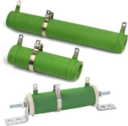
Resistori regolabili a tubo metallico per applicazioni comuni, isolati, per montaggio a soffitto. I resistori sono progettati per essere utilizzati nei circuiti CA e CC, per limitare la corrente e distribuire la tensione. La resistenza del resistore viene regolata modificando la posizione del collare di serraggio mobile (contatto mobile) lungo l'involucro (tubo).
